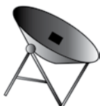
Cuiseur solaire à réflecteur parabolique
